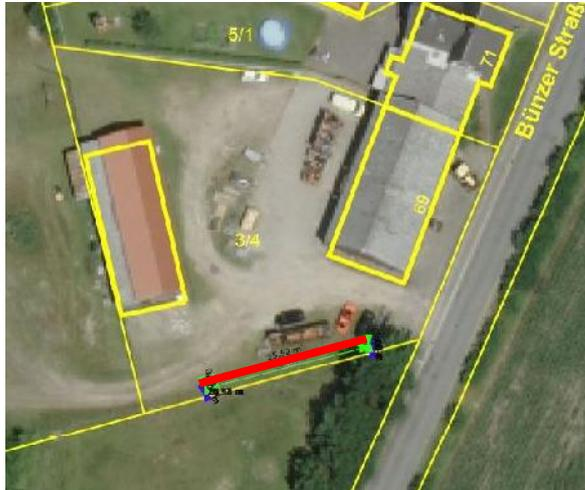
**Abb. 18a** Lage der Lärmschutzwand (rote Liniendarstellung) anhand eines Luftbildes mit der Betriebshof und dem Zufahrtbereich
